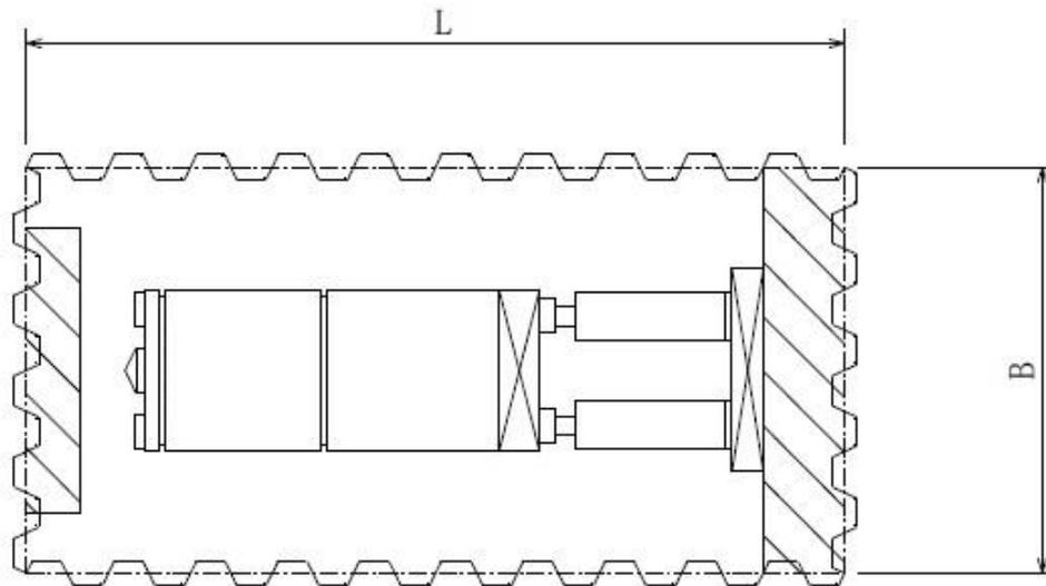
図 7-1 発進・到達立坑(鋼矢板)
