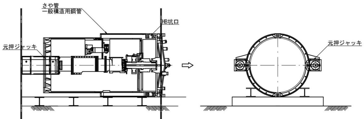
図 9-1 掘進機・鋼製さや管推進設備
