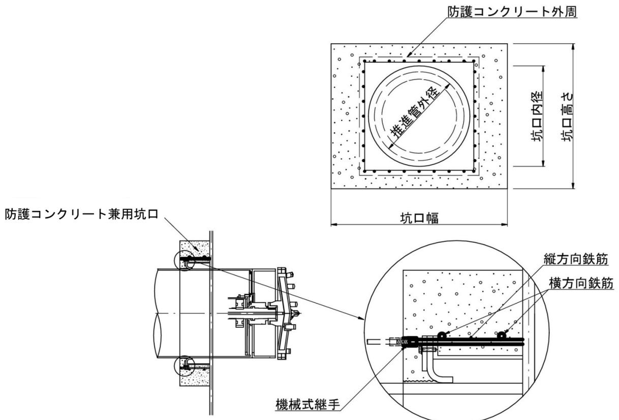
図 9-13 防護コンクリート兼用坑口
