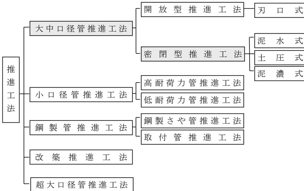
図1-1 推進工法の分類
