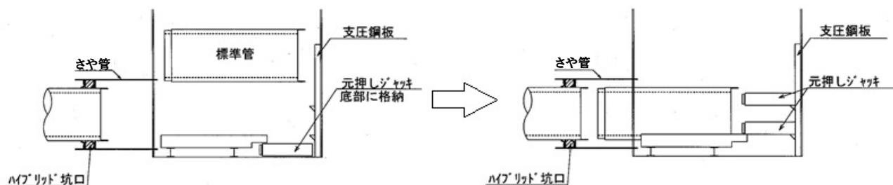
図7-3 コンパクト立坑発進概要図
