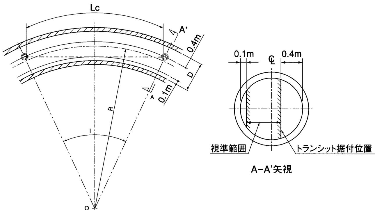
図 6-1 曲線区間での 1 回当たりの測量長・曲線長の関係
