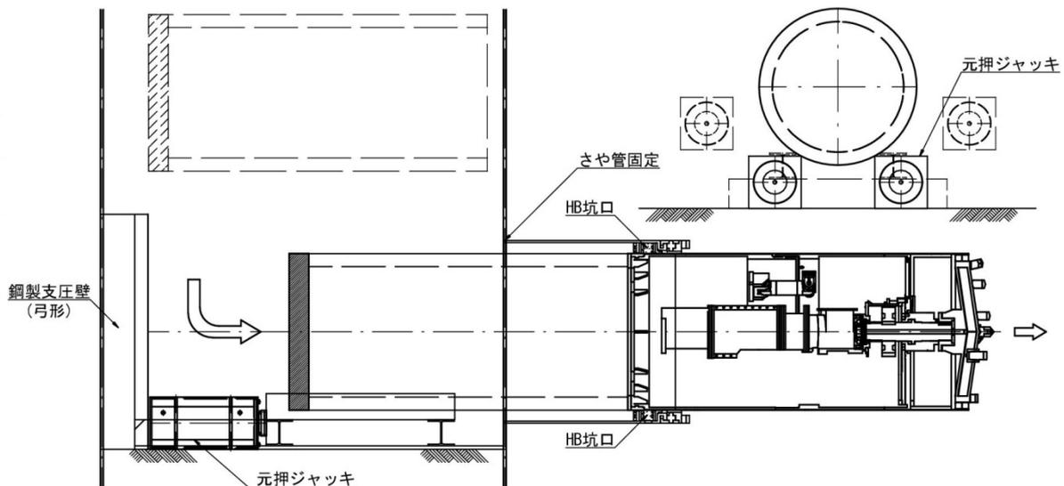
図 9-2 推進管（標準管）の据付
