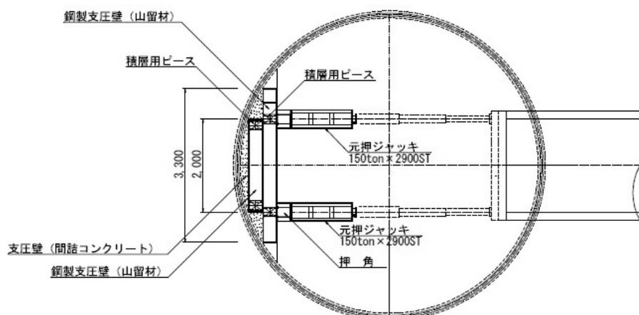
図7-9 提案の鋼製支圧壁使用例
