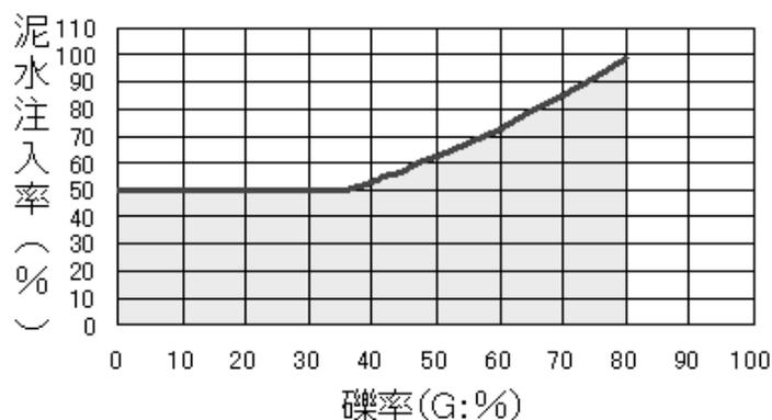
図3-1 礫率と高濃度泥水注入率（砂礫土）
