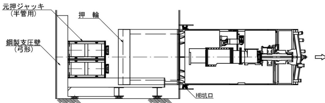
図 9-10 推進管 (半管) の据付
