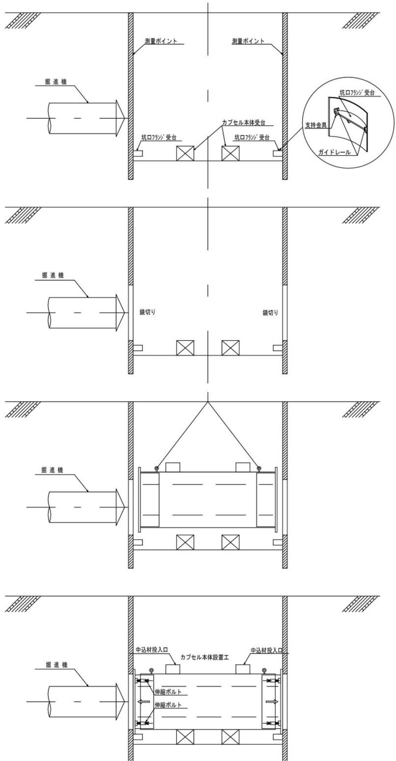
図 9-16 施工手順図 - 1
