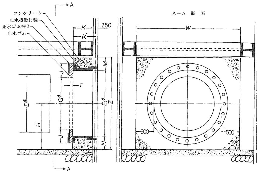
図 7-6 発進坑口設備の取付け関係
