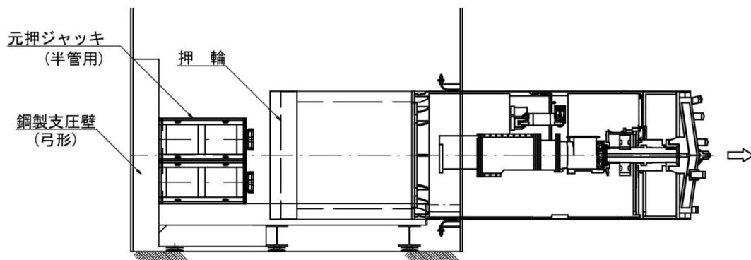
図 9-7 推進管 (半管) の据付
